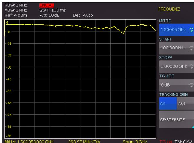
Abb. 6.7: Tracking Generator Messung nicht abgeglichen
