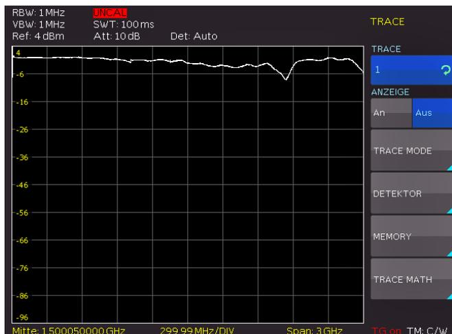
Abb. 6.8: Anzeige der gespeicherten Kurve (Show Memory)
