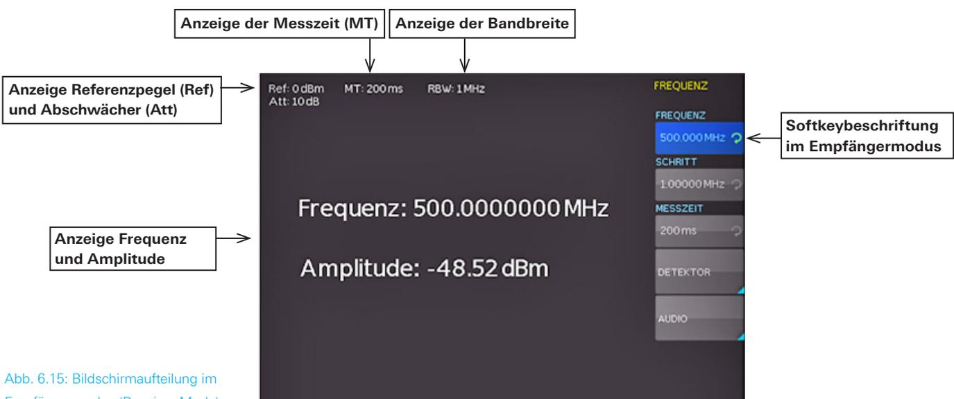
Abb. 6.15: Bildschirmaufteilung im Empfängermodus (Receiver-Mode)
